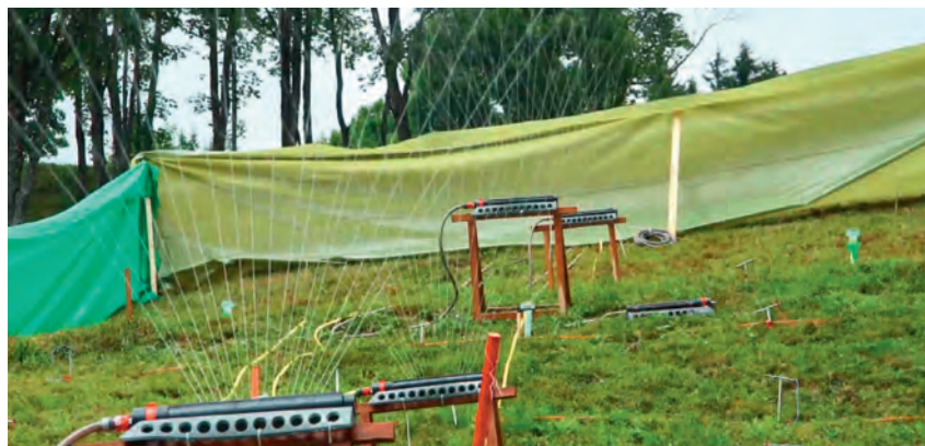
Ein Hang im Einzugsgebiet des Schächens wurde mit über 700 mm künstlich beregnet, um den Verlauf des Grundwasserspiegels und des unterirdischen Abflusses bei extremen Niederschlagsereignissen nachvollziehen zu können
